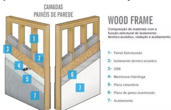
Figura 7 Representação das camadas existentes nas paredes de Wood frame
