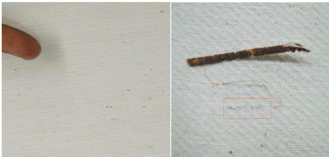
Figura 7. Fio e tecido com presença de materiais não fibrosos. Fonte: Jorge José de Lima, 2011.
