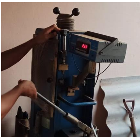
Figura 12 – Rompimento de corpo de prova
