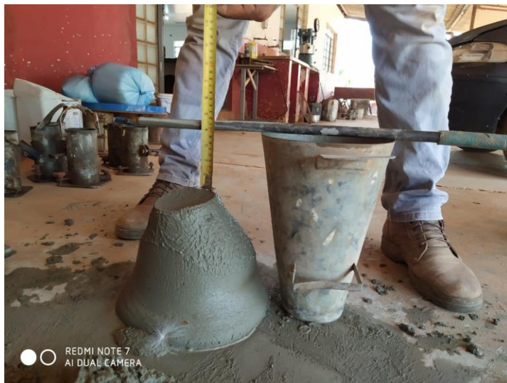
Figura 8 – Slump test da argamassa com abatimento de 95mm
